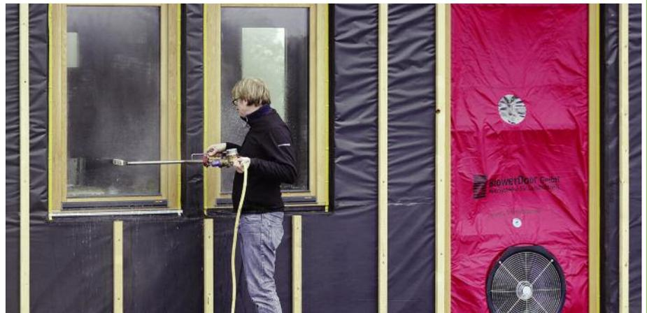
Die Messung wird idealerweise in Kombination mit einem BlowerDoor MessSystem durchgeführt. Bei Unterdruck im Gebäude lassen sich insbesondere auch kleine Leckagen zuverlässig erkennen. Die Diagnostik und Dokumentation kann optional durch eine Wärmebildkamera unterstützt werden. Für mehr Informationen bzw. Bestellungen klicken Sie bitte [hier](#).
